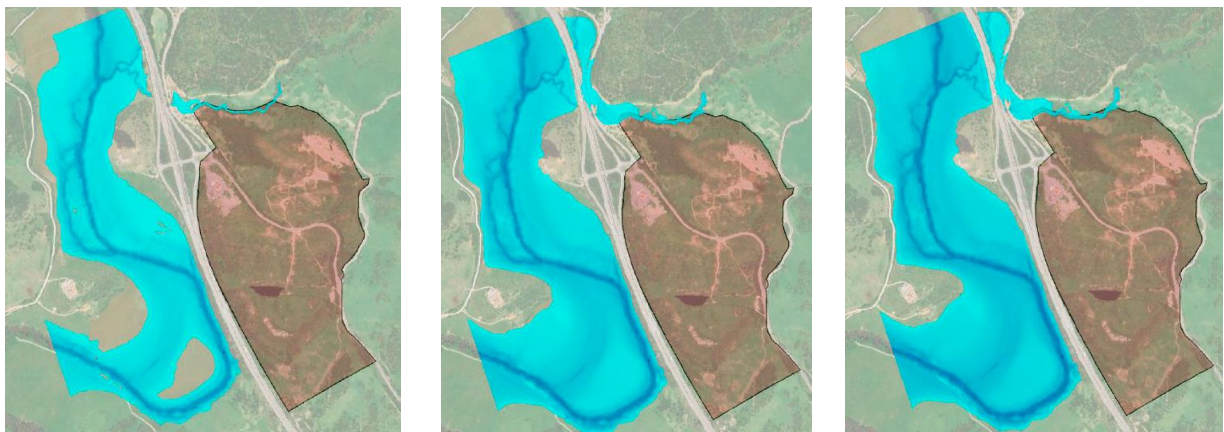
Figura 14. Zona inundable para la avenida de 10, 100 y 500 años de periodo de retorno en estado actual.
